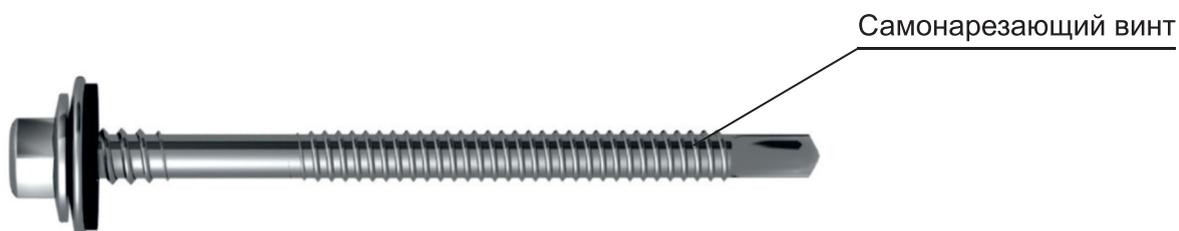
В качестве крепежа для сэндвич-панелей к стальной конструкции применяются самонарезающие винты с антикоррозионным покрытием и резиновой шайбой из EPDM.
